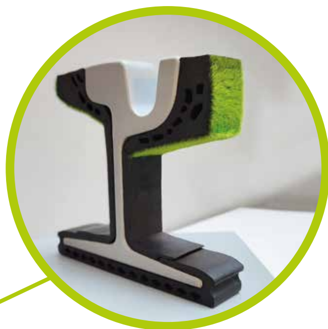
Elektrostatische Beflockung der Seitenprofile als eine alternative Verbindung zwischen Isolation & Deckschicht
